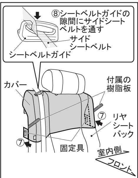
⑦付属の樹脂板を使用して、固定具(2ヶ所)をリヤシートバックとガーニッシュの間に押し込む。
