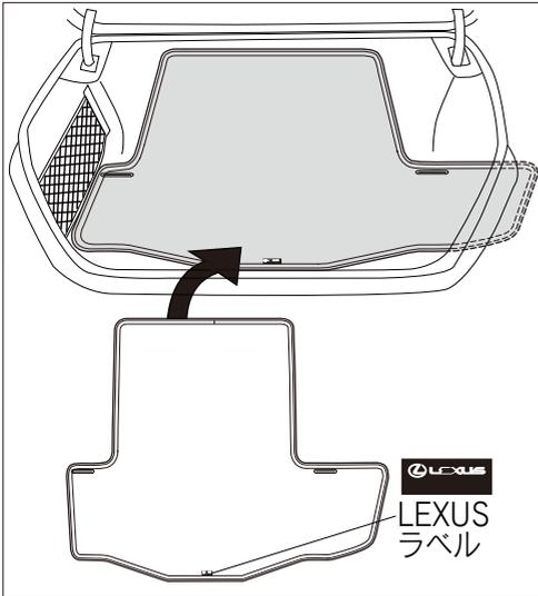
・図は、GAS車を示しますが、HEV車/ADS車も同様に取り付けてください。
