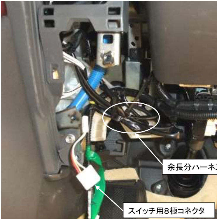
写真4 1. 助手席スイッチハーネス固定
