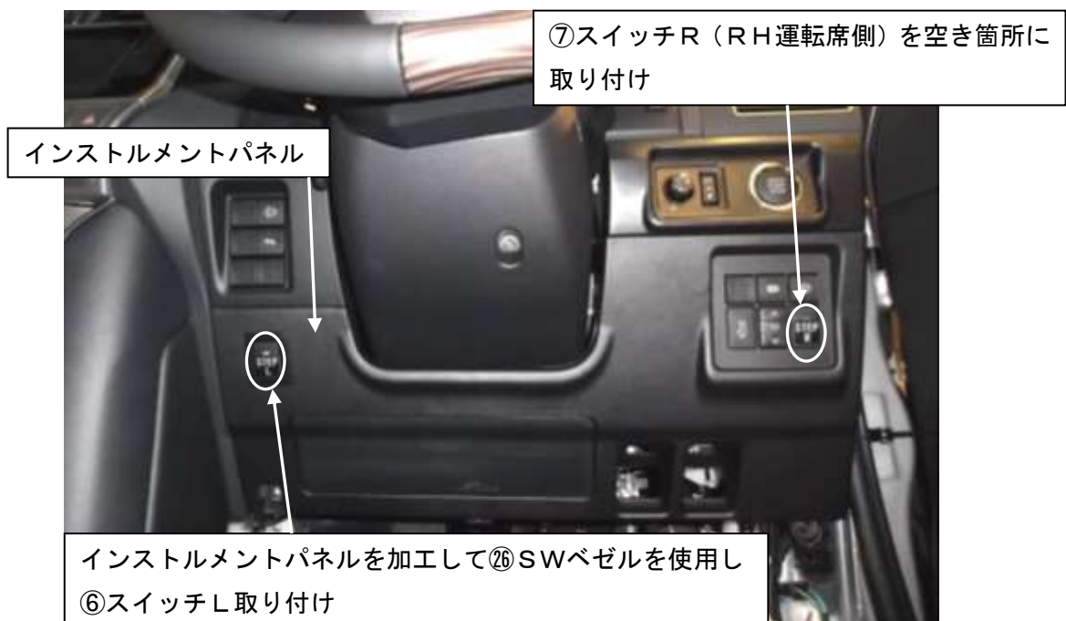
写真35. スイッチ取り付け
