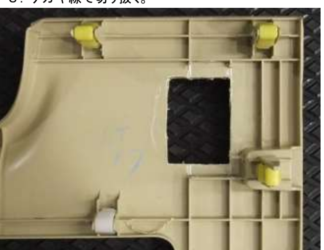
写真40. パネル切り抜き後
