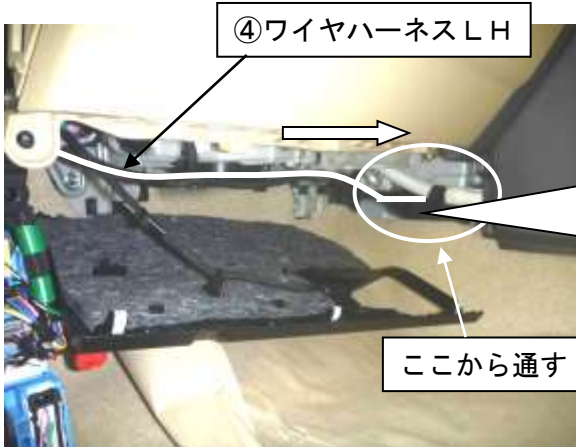
写真17. 助手席グローブボックス付近配線
