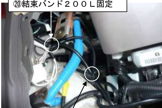
写真4 3. アース線コンベックス固定
