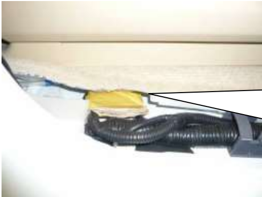
写真 1 1. 緩衝材差込み
