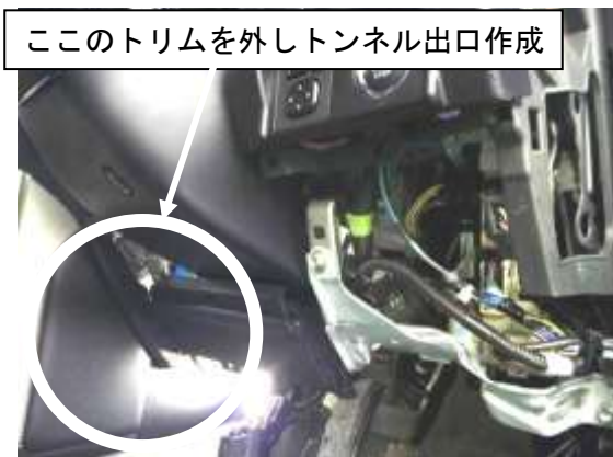
写真9. 運転席センタートンネル出口作成
