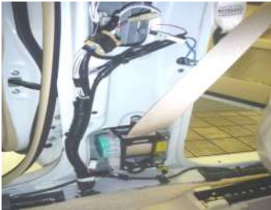
写真5. センターピラーガーニッシュLWR LH取外し
