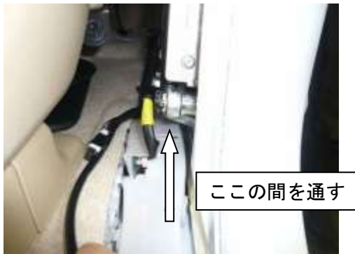
写真25. ベルト行きハーネス付近配線
