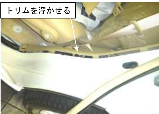
写真6. デッキトリムサイドパネルASSY作業
