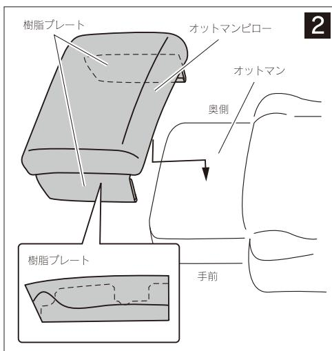
2 (2) オットマンピローの樹脂プレートをオットマンの裏側に差込み装着する。
