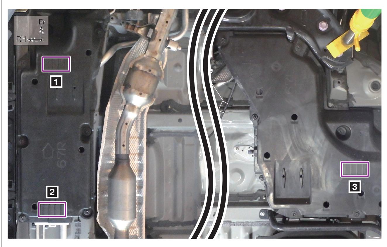
士別フィン取付位置（**1**～**3**）を脱脂剤等で洗浄し、基準位置に従い、フロアアンダーカバーに取り付ける。
