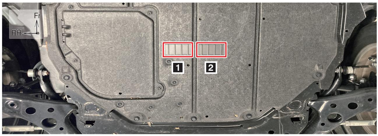
士別フィン取付位置（**1**～**2**）を脱脂剤等で洗浄し、基準位置に従い、エンジンアンダーカバーに取り付ける。
