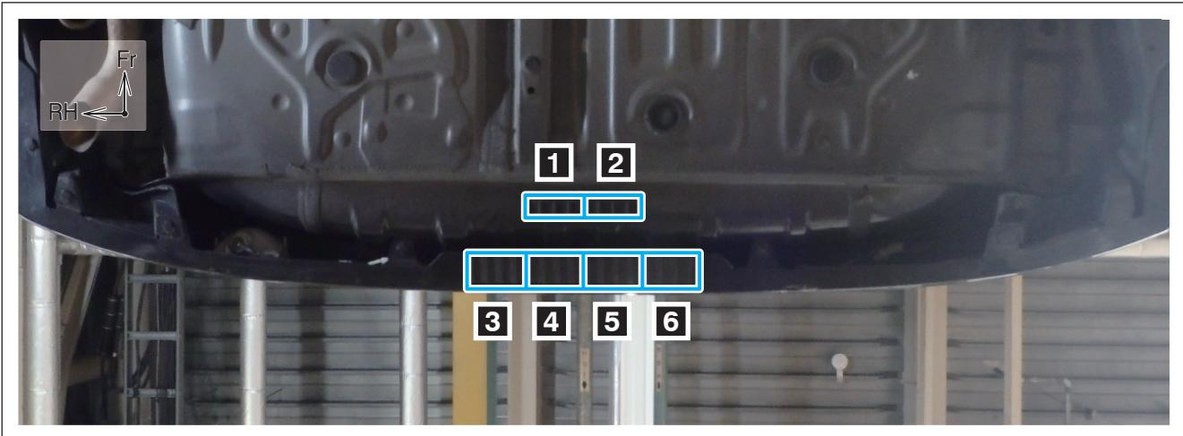
士別フィン取付位置(1～6)を脱脂剤等で洗浄し、基準位置に従い、ラゲージアンダーパネル及びリヤバンパーに取り付ける。
