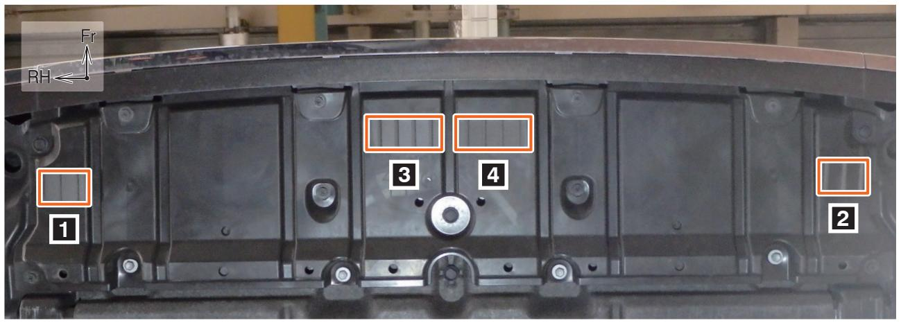
士別フィン取付位置（**1**～**4**）を脱脂剤等で洗浄し、基準位置に従い、フロントアンダーカバーに取り付ける。
