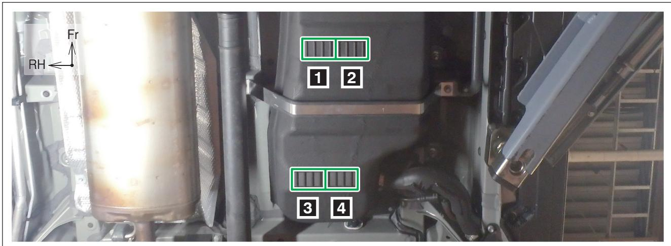
士別フィン取付位置(1～4)を脱脂剤等で洗浄し、基準位置に従い、燃料タンクに取り付ける。
