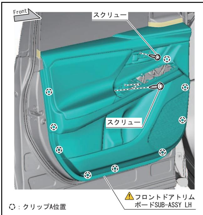
10. 取りはずしと逆の手順でフロントドアトリムボード SUB-ASSY LH を復元する。
