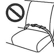
■腰ベルト側に付いたELR (緊急ロック式ベルト巻取り装置) 付シートベルト
